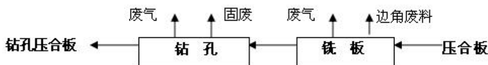
图 1-3 压合板钻孔工艺流程及产污环节
