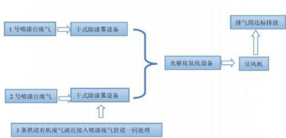
图 3.6 喷漆废气处理工艺示意图
